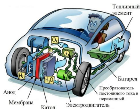
Рис. 1. Устройство автомобиля с водородным двигателем.
